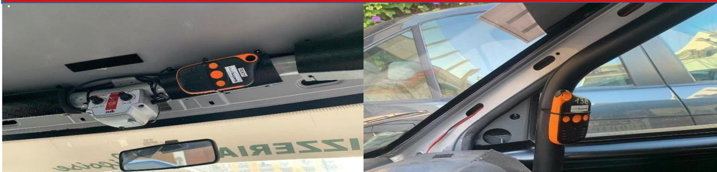
Le boîtier GPS se met en marche et s'arrête avec un appui long de 5 secondes sur le bouton Marche/ Arrêt situé sur le côté droit du boîtier (fig. 1). Dès que le boîtier vibre et que les leds clignotent, il est en fonction.
